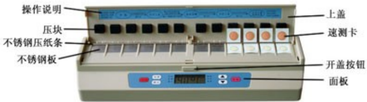
图 2 仪器结构示意图
